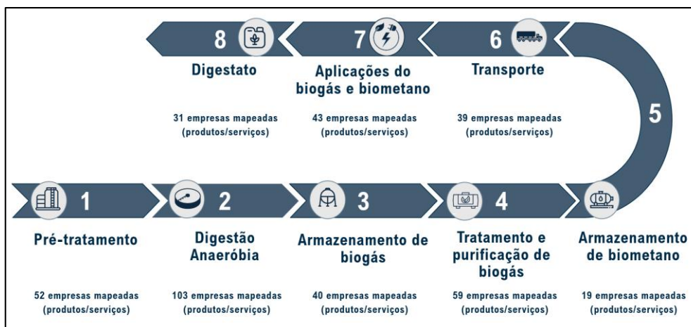
Figura 1: Detalhamento dos Processos Envolvendo Plantas de Biogás e Biometano, e Mapeamento de Fornecedores a Nível Nacional
